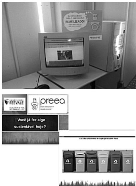
Figura 4: a) Computador montado a partir da reutilização de resíduos eletrônicos e b) Imagem do programa no computador montado a partir da reutilização de resíduos eletrônicos.
