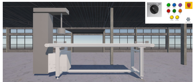
Figura 2: Modelo 3D de la cinta transportadora con troqueladora integrado en Unity.
