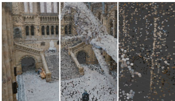
Figura 2: Aplicación de reducción a la nube basada en la selección del 50 %, 15 % y 1 % (de izquierda a derecha).
