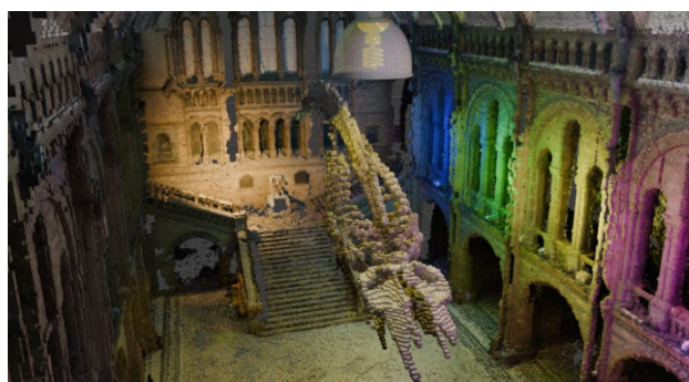
Figura 7: Imagen renderizada de una nube de puntos voxelizada, con cubos instanciados en cada punto, y en cuya escena se han añadido diversos puntos de luz de varios colores e intensidades. Adicionalmente se ha integrado en la escena una malla 3D de una lámpara de techo.
