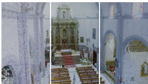
Figura 3 Visualización de una nube obtenida mediante diversos estacionamientos de láser escáner, a la que se le ha aplicado una reducción con selección del 15 % de la nube (izquierda) y una selección del 25 % (centro) y del 90 % (derecha) de la nube con una voxelización de tamaño 0,05 m.
