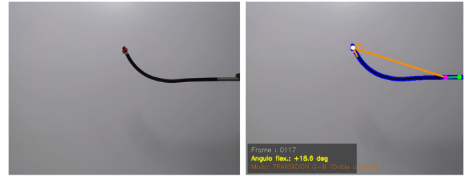
Figura 3: Comparación entre un fotograma original y el resultado anotado por el algoritmo de visión. La superposición muestra el contorno segmentado, los puntos geométricos empleados y los vectores utilizados para calcular el ángulo distal.
