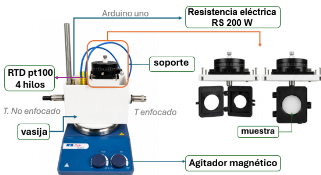
Figura 2: Montaje experimental empleado para la caracterización ultrasónica de las muestras de PVA-propilenglicol.
