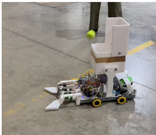
Figura 8: Fase de recogida automática del objeto mediante el sistema de succión, coordinado por el controlador autónomo tras la detección de la pelota.
