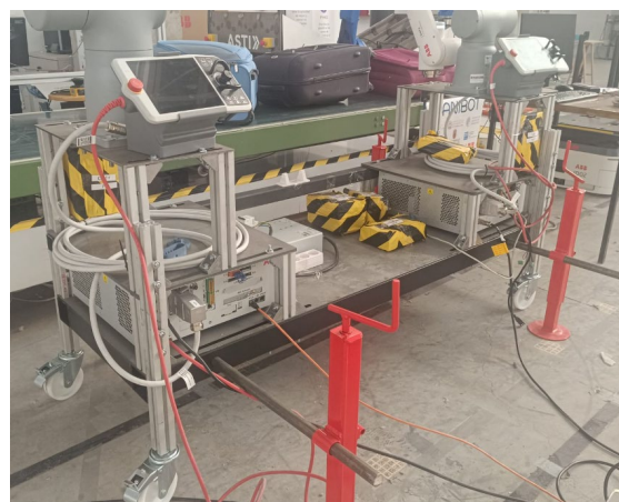
Figura 7: Plataforma estructural levantada mediante sistema de elevación para permitir el acoplamiento de diferentes AMRs.
