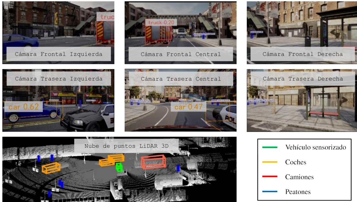
Figura 5: Detección de coches, camiones y peatones sobre imágenes RGB y una nube de puntos LiDAR 3D.
