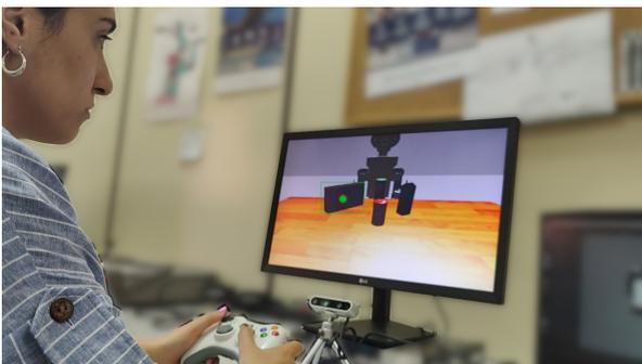
Figura 6: Un usuario controla la cámara del simulador mediante un mando, mientras una cámara captura y estima su mirada, mostrando el punto de fijación estimado en la pantalla.
