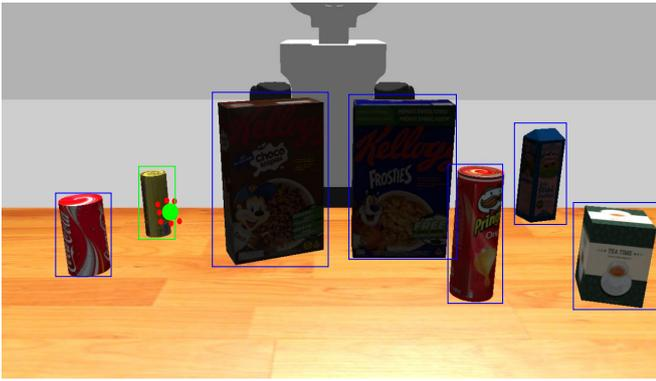
Figura 5: Puntos de mirada del usuario (rojos) durante una ventana I-DT y su media (verde). El bounding box verde indica el objeto seleccionado, que contiene la media de los puntos de mirada.
