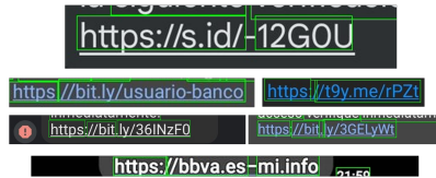
Figura 5: Errores de localización de URLs en el método utilizado. La separación de URLs se une a la omisión de ciertos componentes, además de la confusión entre caracteres similares, que disminuye la precisión final del modelo.
