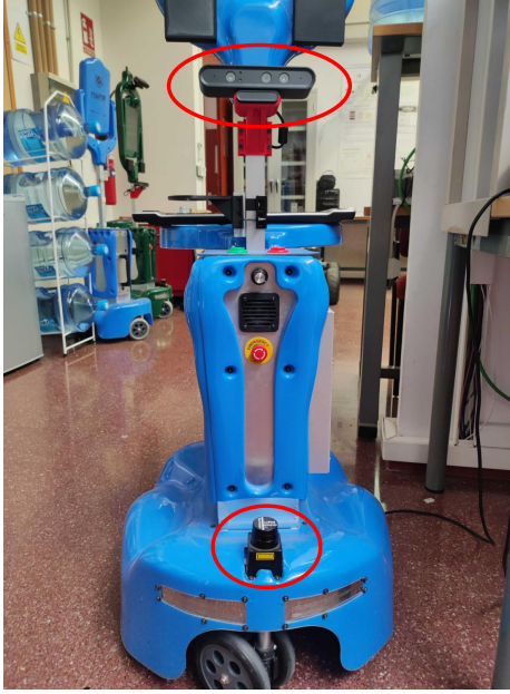
Figura 2: Montaje del hardware. La cámara se coloca en la misma vertical que el láser, de manera que sus FoV se superpongan.
