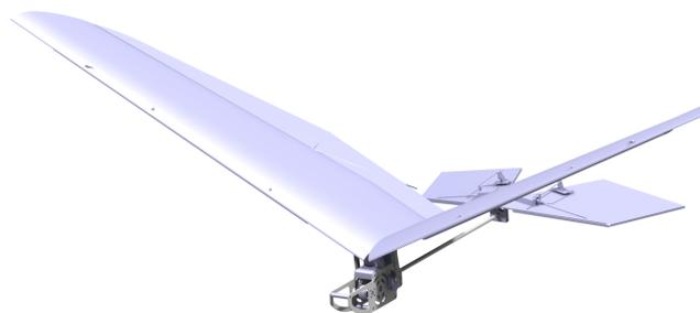
Figura 2: Diseño CAD de nuestro robot de ala batiente.
