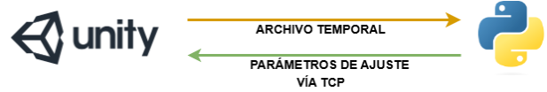
Figura 8: Esquema de comunicación entre programas para actualización de la generación eléctrica en el gemelo digital.
