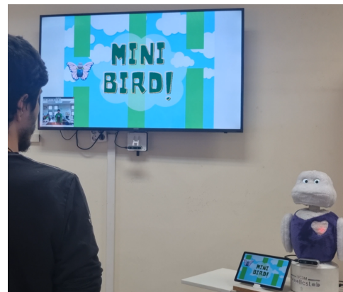
Figura 2: Escenario de interacción humano-robot. Se muestra al robot social Mini encima de una mesa junto a su tableta auxiliar, y al AJ conectado a un televisor.
