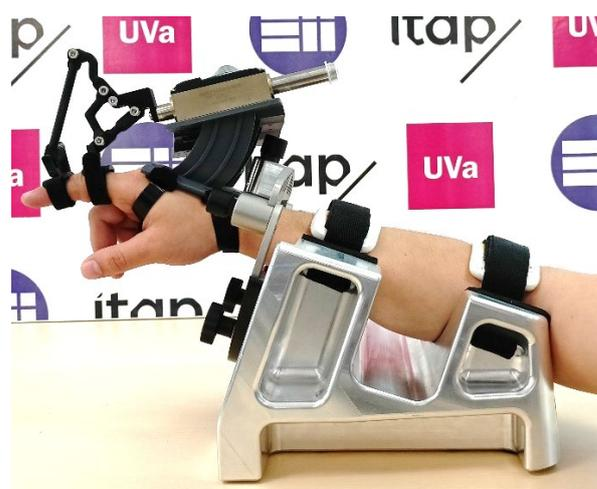
Figura 2: Prototipo de exoesqueleto para la rehabilitación de dedo: actualización de RobHand con el nuevo motor.
