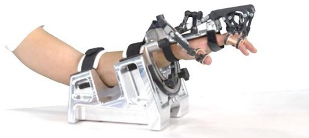
Figura 1: Exoesqueleto de rehabilitación de mano RobHand.
