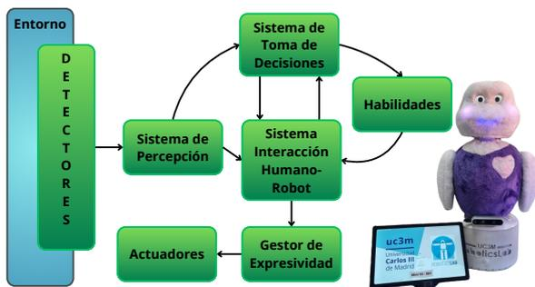
Figura 1: Arquitectura software del robot Mini.
