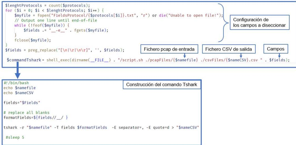
Figura 1: Construcción del comando Tshark de forma dinámica
