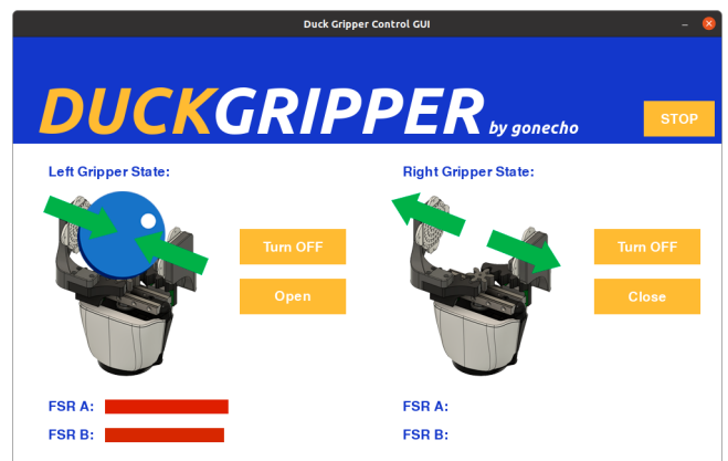
Figura 5: Interfaz gráfica de usuario para el uso de las pinzas Duck Gripper. Al cerrar la garra izquierda sobre un objeto la interfaz muestra la retroalimentación de los sensores.
