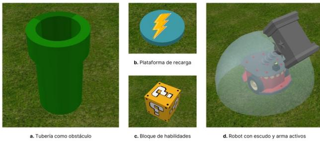
Figura 2: Representación de los diferentes elementos de la simulación. El robot móvil está basado en un Pioneer 3-DX dotado de un sensor láser. En la figura se muestra la situación en la que dispone de la habilidad de escudo y arma de ataque.
