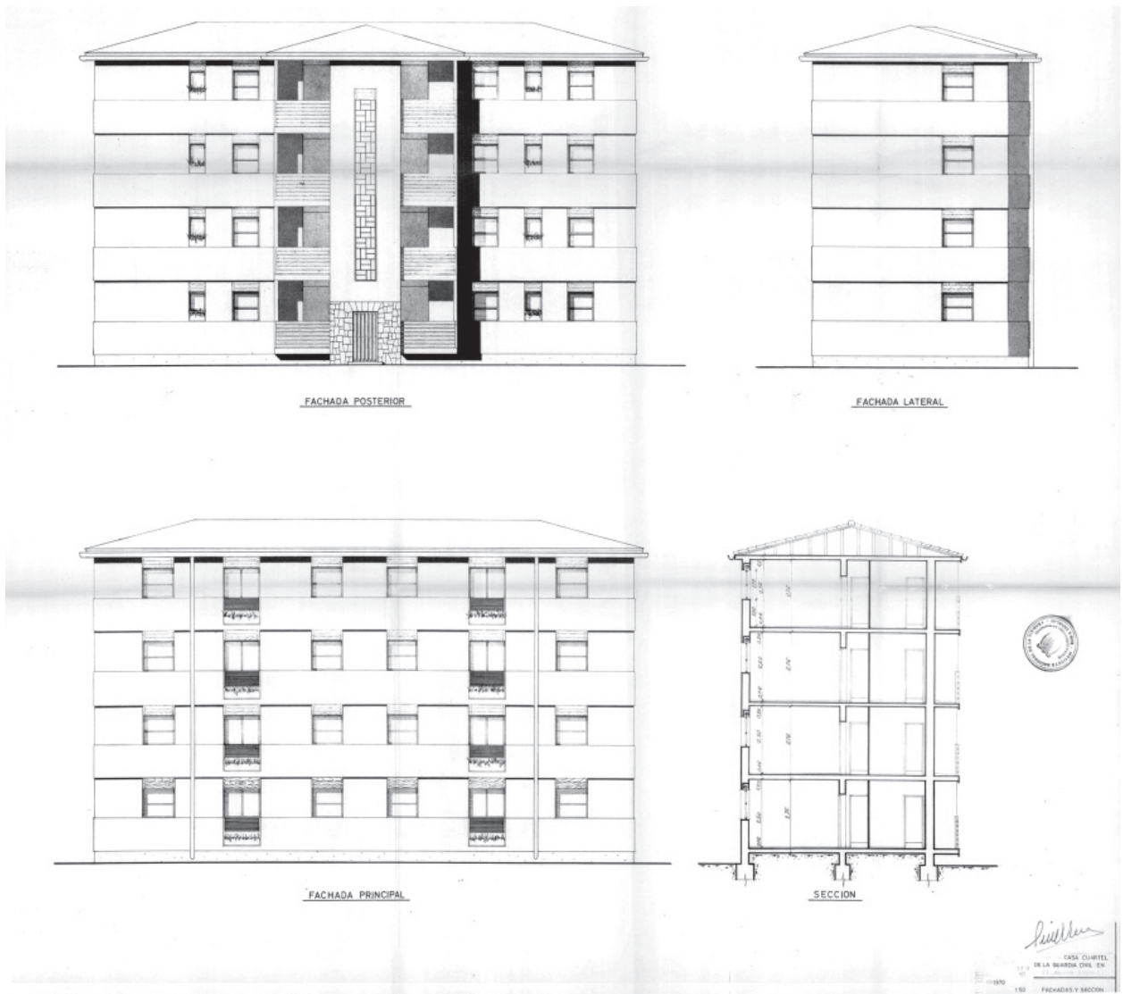
15 Felipe García-Escudero Torroba, casa-cuartel de Celanova (Ourense), 1970; plano tipo de fachadas y sección.
